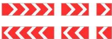
1.34.1, 1.34.2 "Направление поворота". Направление движения на закруглении дороги малого радиуса с ограниченной видимостью. Направление объезда ремонтируемого участка дороги.
