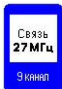
7.16 "Зона радиосвязи с аварийными службами". Участок дороги, на котором действует система радиосвязи с аварийными службами в гражданском диапазоне 27 МГц.
